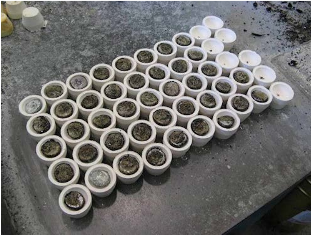
11.6 ábra: Tűzi eljárással történő feltárára előkészített ércminták nemesfémvizsgálásra Az űzőkében lévő mintákat ólommal együtt kemencében olvasztják meg.
