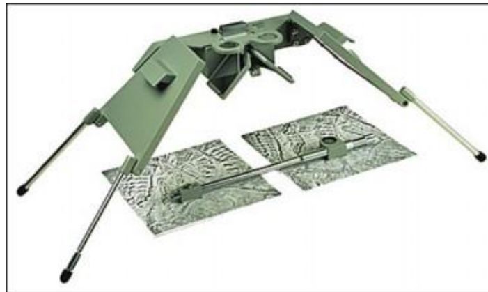
4-6. ábra Tükrös sztereoszkóp. Forrás: www.benmeadows.com/images/xl/SOKKIA-Mirror-St...
