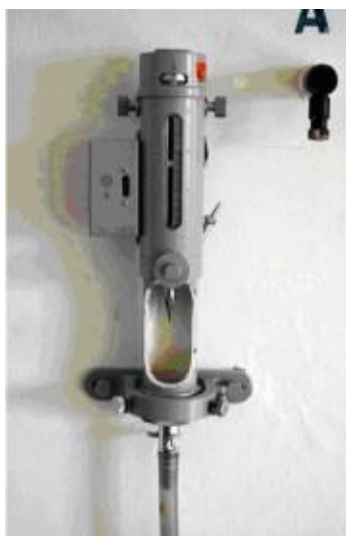
13-14. ábra A Meisser-féle hidrosztatikai szintezőműszer
