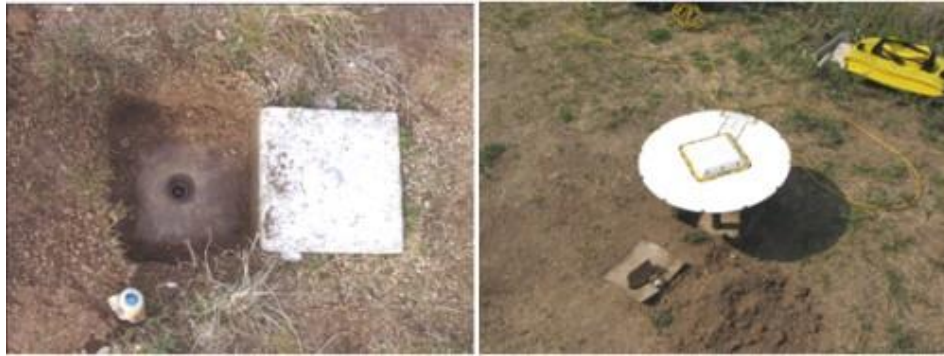
3-17. ábra Csavarmenettel ellátott háromdimenziós pontjel és a rézrúdra erősített GPS antenna
