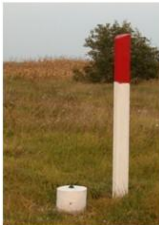
3-3. ábra Szintezési kő (kőben gomb), mellette jelzőoszlop
