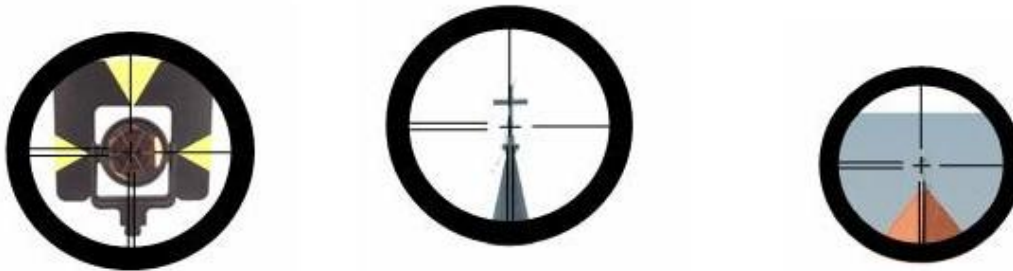
5-19. ábra Irányzás végrehajtása: prizma jeltáblával, valamint magaspontok vízszintes értelmű irányzása (Gyenes, 2005)
