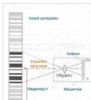
9-9. ábra A digitális szintezőműszer geometriai működésének elve.
