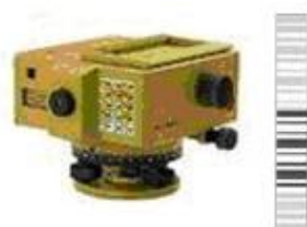
9-8. ábra A Leica NA 2000 digitális szintezőműszer és a hozzá tartozó bárkódos lécek egy szakasza
