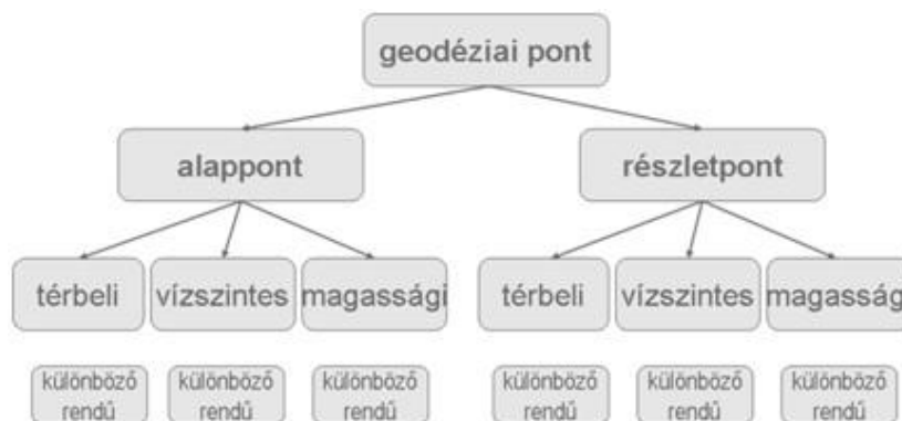
1-2. ábra. A geodéziai pontok csoportosítása
