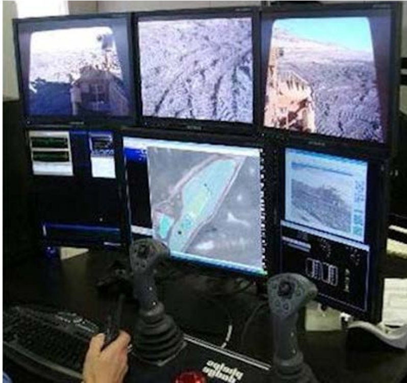
2.9 ábra: A svédországi Kiruna automatizált vasércbánya irányítóterme
