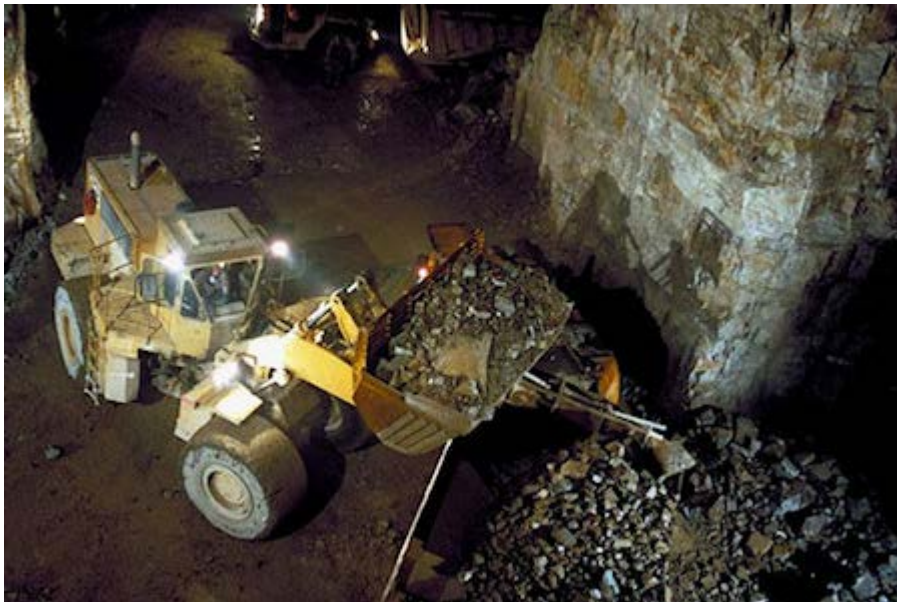
2.6 ábra: Tömedékelés alkalmazása kamrafejtésnél
