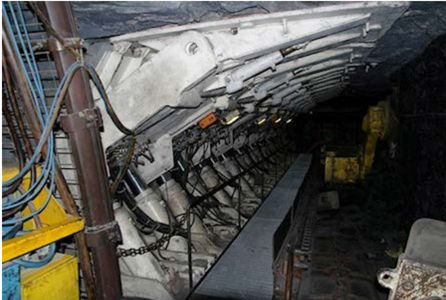
2.5 ábra: Frontfejtés hidraulikus támoikkal
