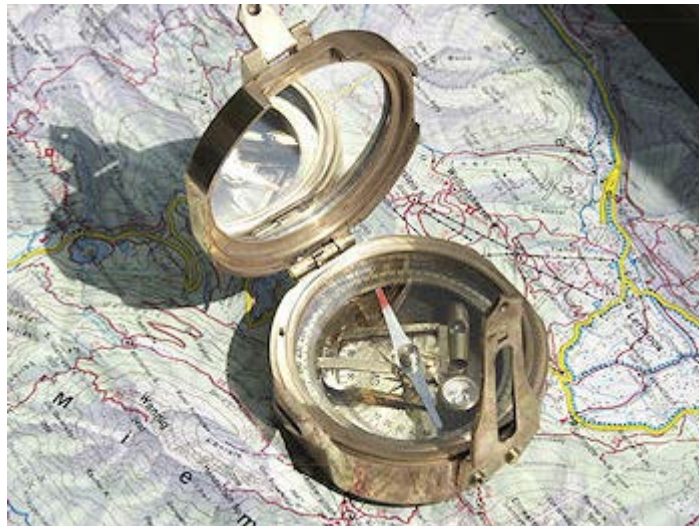
4.2 ábra: Geológuskompasz, klinométtel
