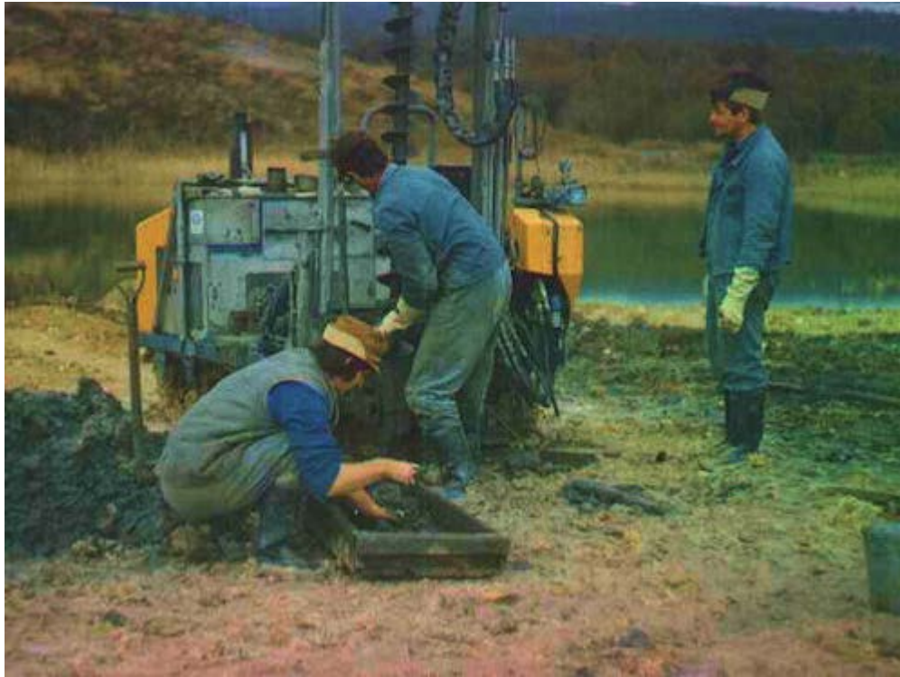
8.8 ábra: Spirálfúrógép fúrószáraán megtapadt furadékanyag mintázása. Lahóca meddőhányó 1993 [iii]
