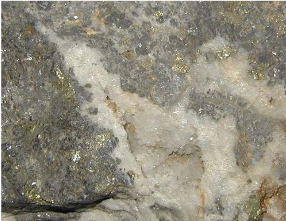
8.10 ábra: Piritben gazdag, nyomokban kalkopiritet tartalmazó, nyitott repedésrendszert kitöltő teléres érces szakasz képe, a kép hosszabbik élének hossza 3 cm. GyöngyöSOROSZI F7 fúrás [iv]
