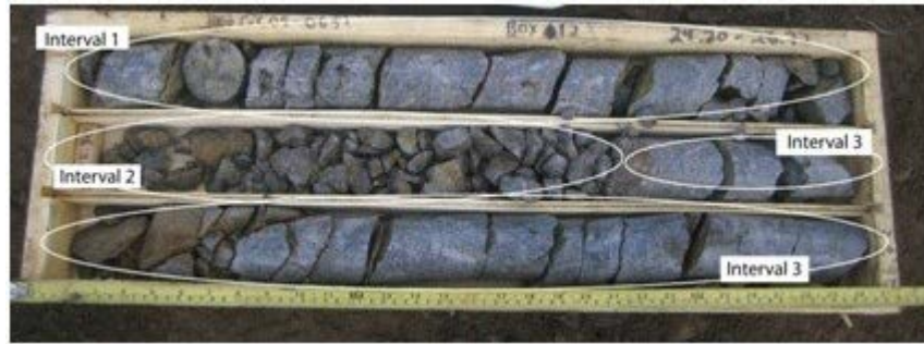
8.5 ábra: Töredezett fúrómag – az 1. szakaszon az RQD 40%, a 2. szakaszon 0%, a harmadik szakaszon 60%
