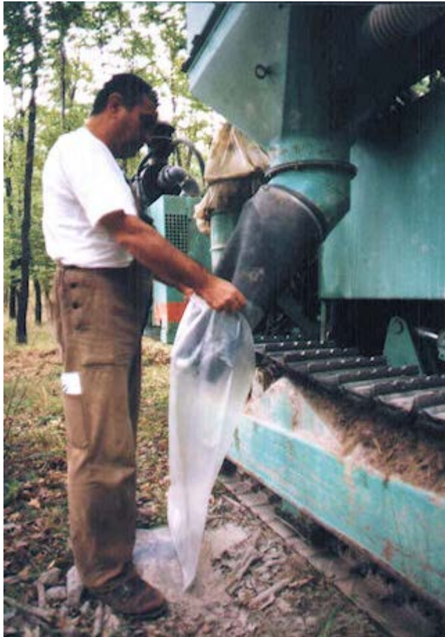
8.7 ábra: Ütvműködő fúrógép porleválasztójában összegyűjtött furadékanyag mintázása, Parádfürdő, aranyérckutatás [1]
