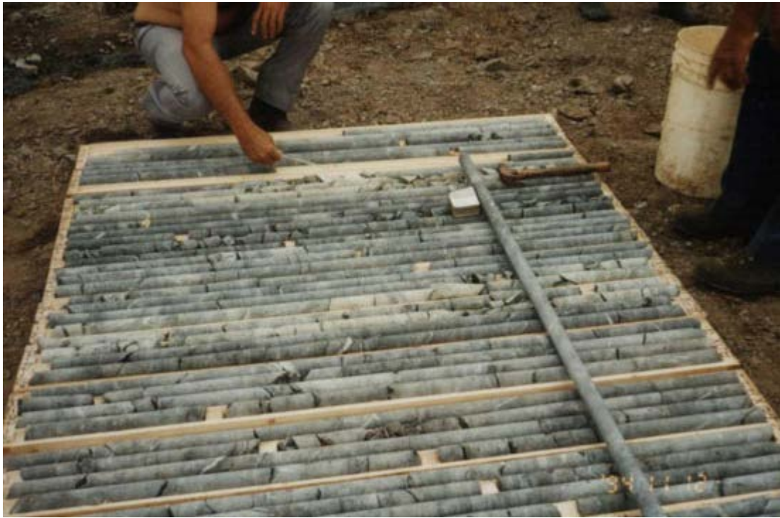
8.3 ábra: Érckutató fúrás fúrómagsorozata
