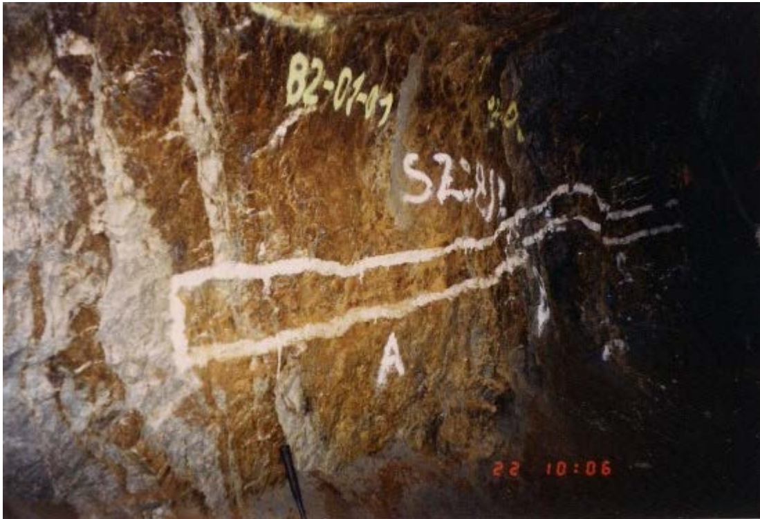
10.2 ábra: Részinta jelölése sziderittelér teljes szélességében, Mária bánya 8. szint, Rozsnyó, Szlovákia, Zelba sro.
