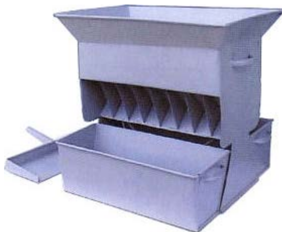
10.5 ábra: Laboratóriumi mintafelező (riffle) szemcsés anyagokra
